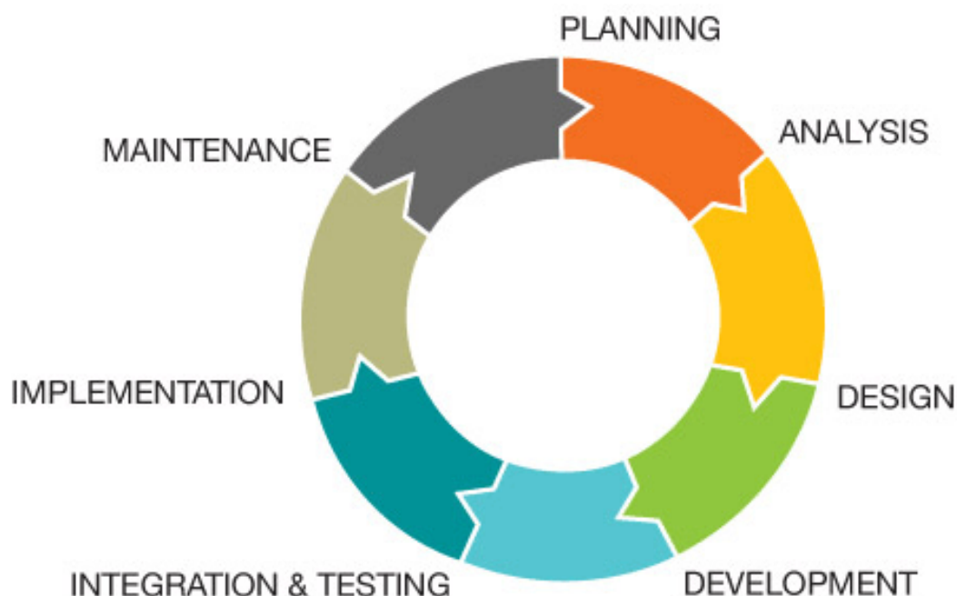
ภาพที่ 2-4 ขั้นตอนการพัฒนาระบบแบบ SDLC
